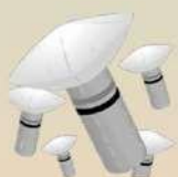
Phase 3 : Déploiement d'un parachute pour freiner la chute de sous-munition
